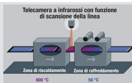
Rappresentazione di un impianto per la tempra del vetro
