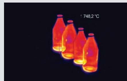
Misurazione del punto caldo nella produzione di bottiglie
