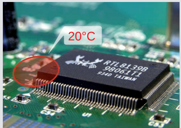
Dimensione spot troppo grande, ciò induce ad un errore nella misurazione
