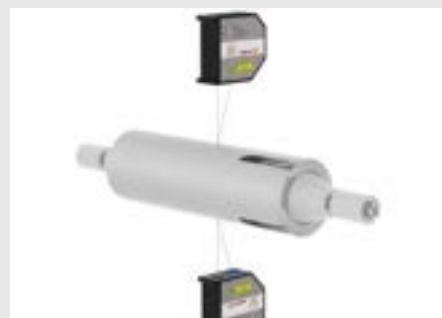
Verifica della concentricità dei rulli
