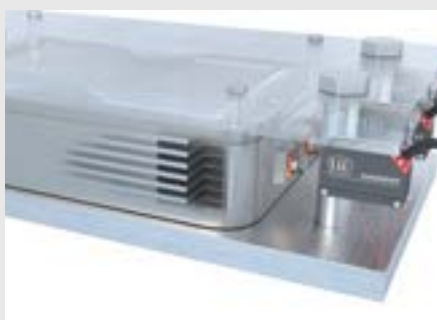
Monitoraggio dell'espansione delle celle delle batterie
