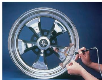
Misura di gradienti di tensioni su una ruota in lega
